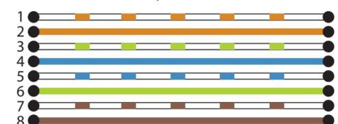
Если Вы подключаете контроллер через switch, либо напрямую (для актуальных систем), то используйте прямую схему обжимки
