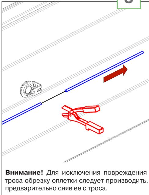
**Внимание!** Для исключения повреждения троса обрезку оплетки следует производить, предварительно сняв ее с троса.
